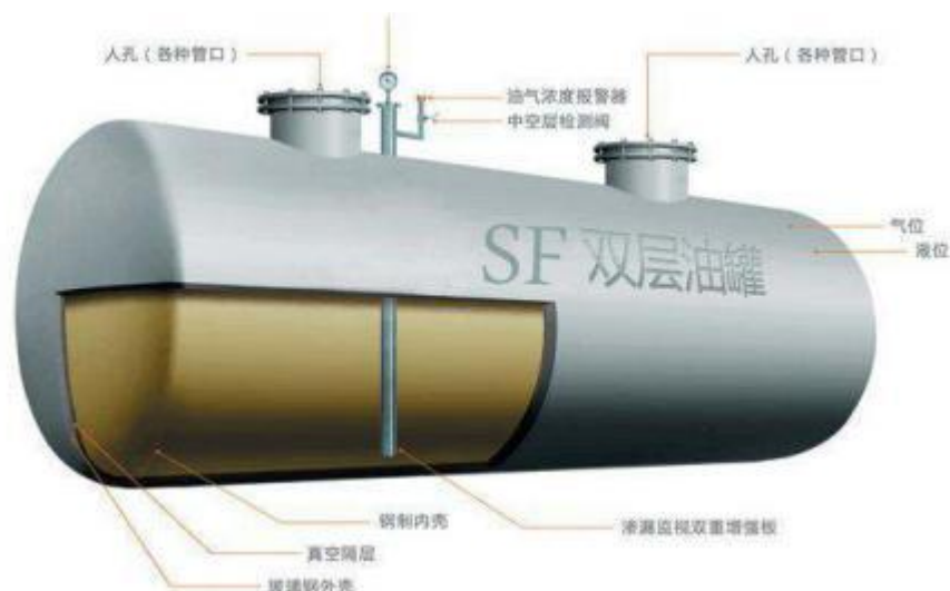
图 3.5-7 双层油罐剖面图
