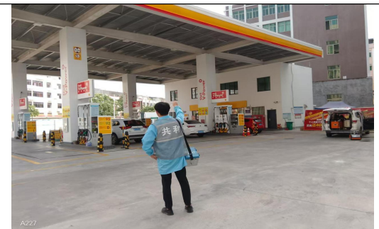
无组织废气检测（厂界）
