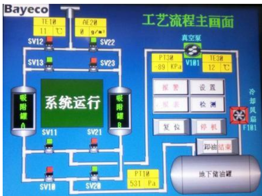
图 3.5-6 三次油气回收系统
